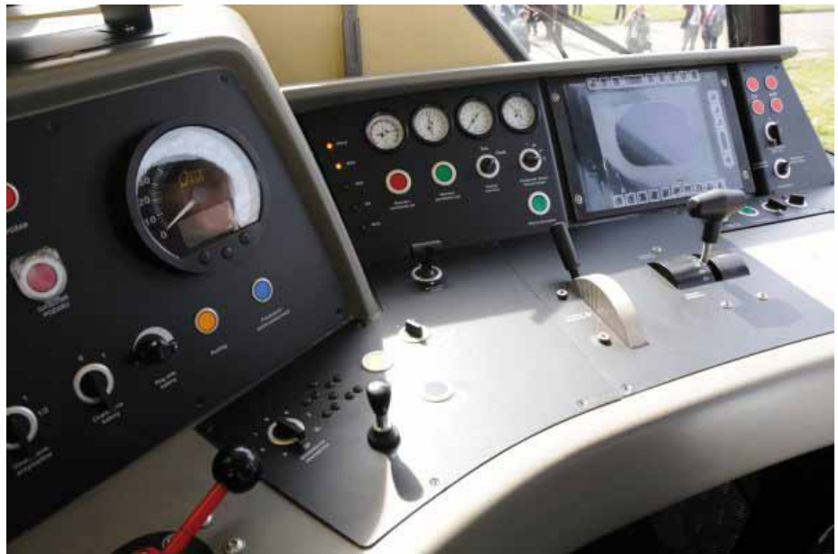
3. Pulpit lokomotywy 15D/16D
