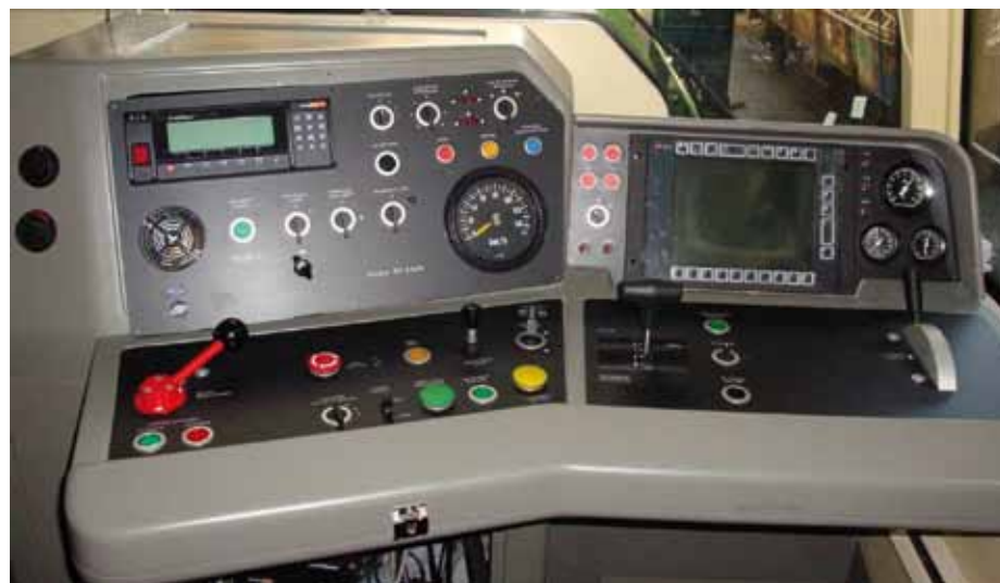
8. Pulpit lokomotywy 6Dg
