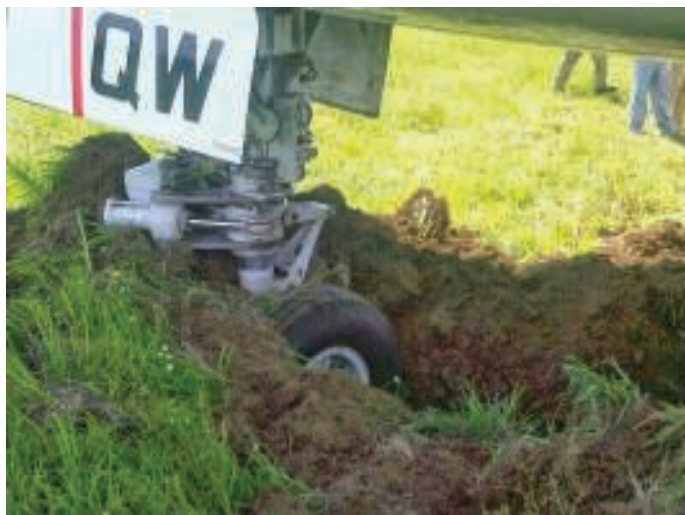
1. Prezentacja skutków niedostatecznej nośności naturalnej nawierzchni lotniskowej [8]
