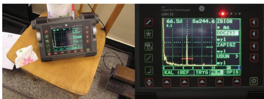
5. Przykład wykorzystania ultradźwiękowej techniki echa [10]
