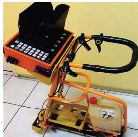
9. Wózek RDM-12 do badania szyn kolejowych [8]
