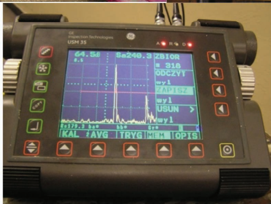
7. Przyrząd do badania techniką Tandem [10]
