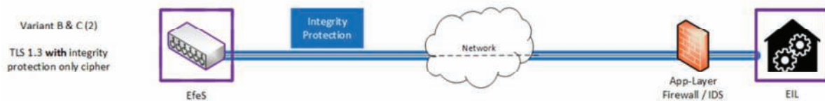
6. Połączenie między sterownikiem obiektowym a cyfrowym interlockingiem [7]
