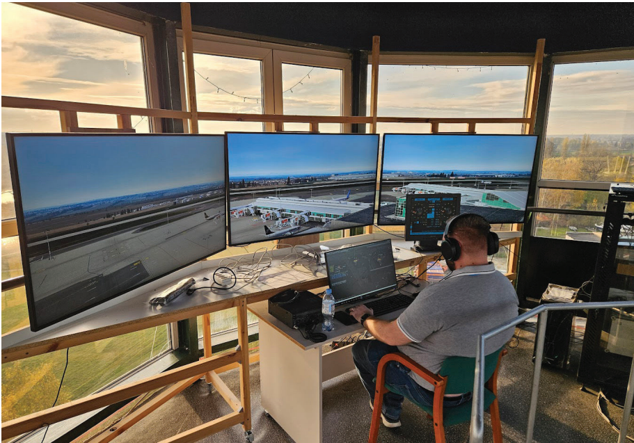
2. Symulator wieżowy ze skanerem lotniczym pozwalającym na nasłuch rzeczywistych częstotliwości lotniczych
