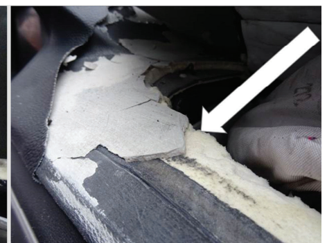
1. Naprawa niezgodna ze sztuką, sprzecznie z homologacją wydaną na ten pojazd. VOLVO S80 T4 2012
