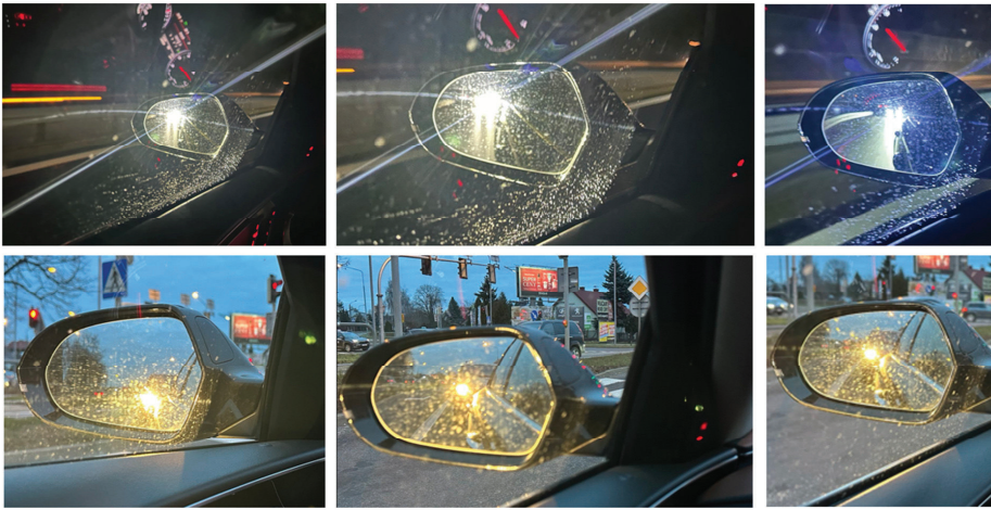
6. Wpływ nieprawidłowo ustawionego oświetlenia na oślepienie innych uczestników drogi
