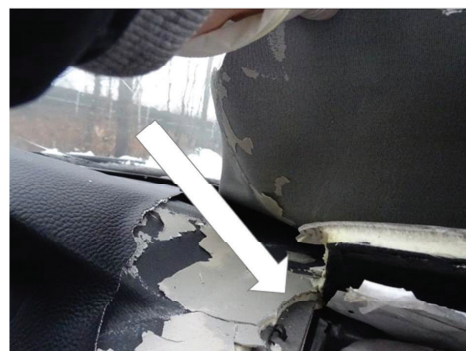
1. Naprawa niezgodna ze sztuką, sprzecznie z homologacją wydaną na ten pojazd. VOLVO S80 T4 2012
