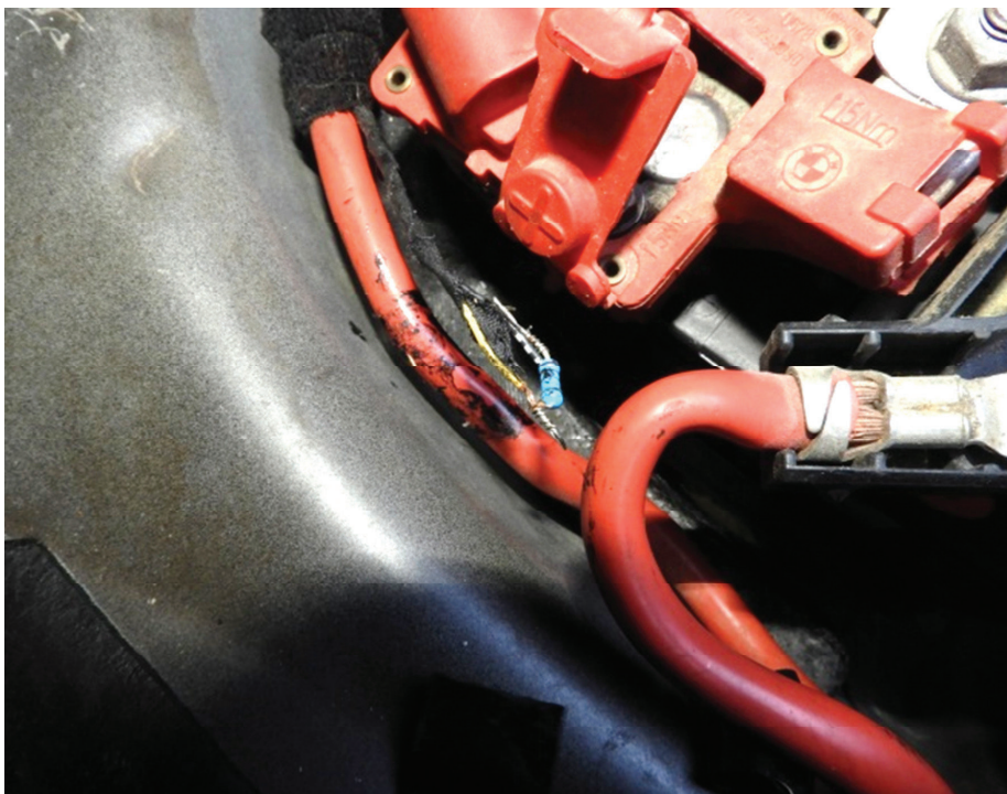
2. Naprawa niezgodna ze sztuką. Pirotechniczny rozłącznik akumulatora „połączony na krótko”, poprawność działania w systemie, zasymulowana opornikiem. Stan pojazdu po naprawie sprzeczny z homologacją wydaną na ten pojazd
