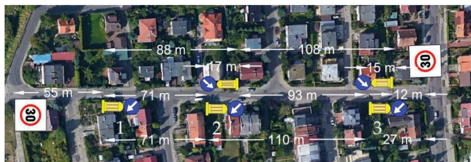
7. Rozmieszczenie szykan na ul. Jagodowej (Źródło: opracowanie własne)
