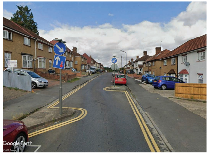
2. Przykład shykany składającej się z dwóch przesuniętych wysp trójkątnych (typu pinch point), zlokalizowanej na przedmieściach Dorchester w Wielkiej Brytanii (Źródło: Google Earth – Street View)
