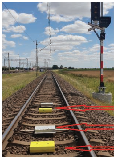
3. Sposób instalacji prototypów eurobalis na torze badawczym [oprac. własne]
