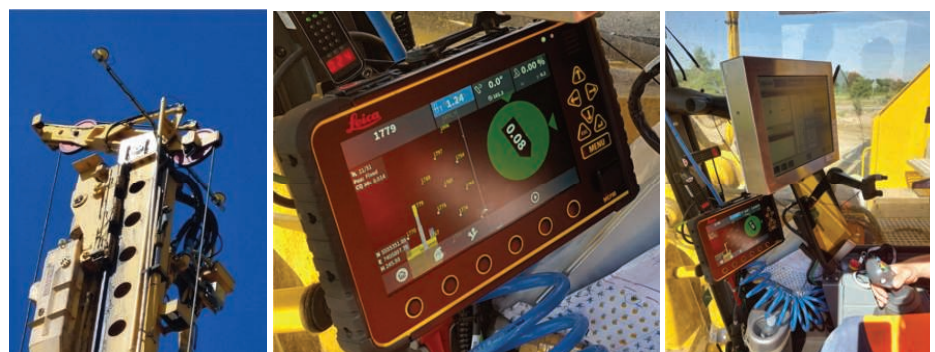
6. Maszyna wyposażona w system pozycjonowania GPS [4]
