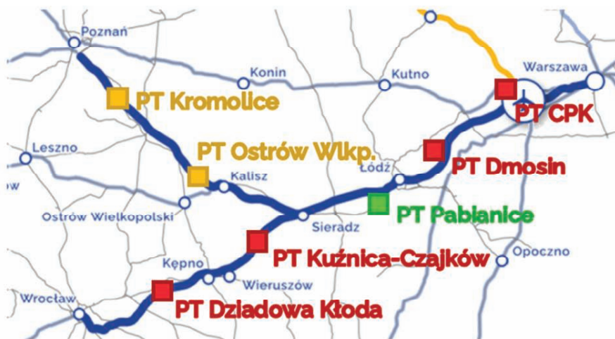
6. Podstacje trakcyjne 2x25 kV AC na linii „Ygrek”. Kolor czerwony – napięcie 400 kV, kolor zielony – napięcie 220 kV, kolor żółty – napięcie 110 kV.
