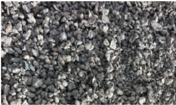
3. Recyklowane kruszywo betonowe uzyskane po przekruszeniu płyt
