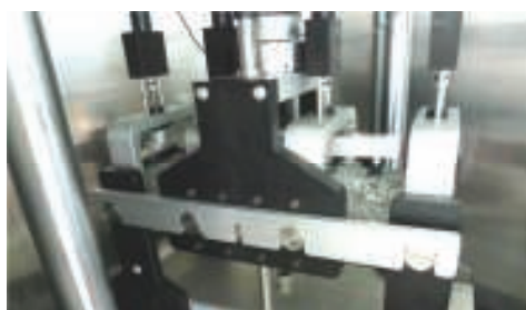
11. Maszyna wytrzymałościowa z wkładką do badań belki 4 punktowej 4PB
