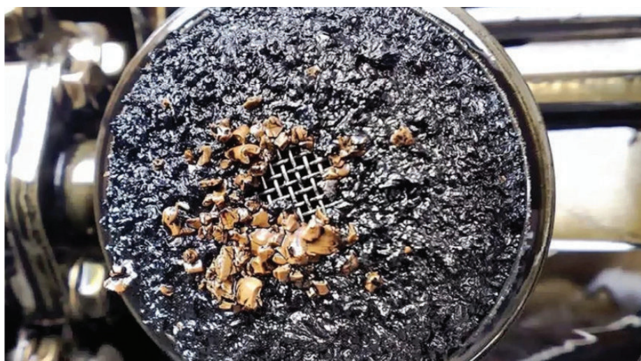
5. Szlam na separatorze smoka oleju w misce oleju z widocznymi zużytymi wiórami prowadnic łańcucha rozrządu [8]
