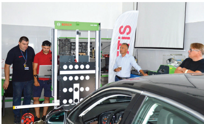
7. Szkolenie personelu technicznego podczas kalibracji kamer i radarów umieszczonych z przodu pojazdu [źródło: BETIS]
