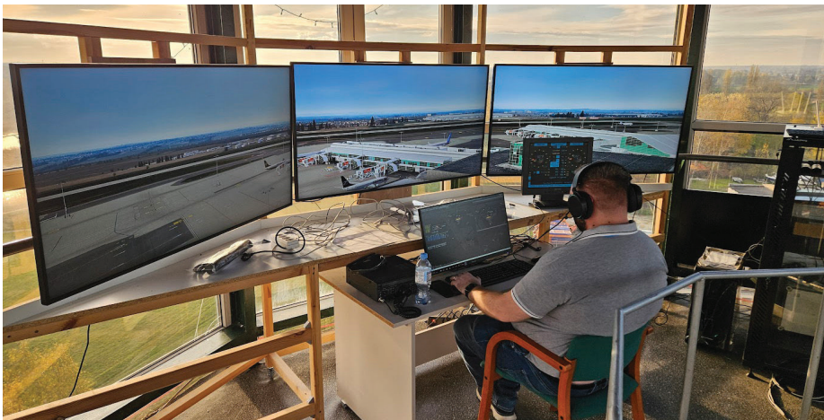
2. Symulator wieżowy ze skanem lotniczym pozwalającym na nasłuch rzeczywistych częstotliwości lotniczych
