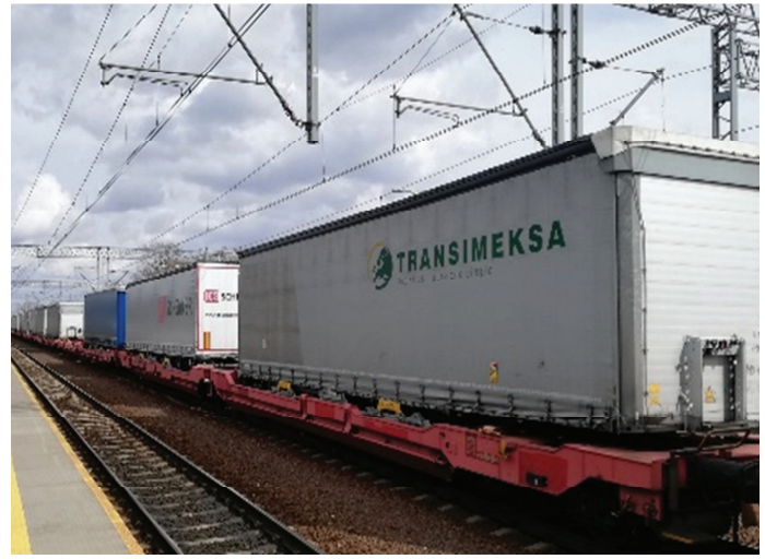
4. Podsystem przewozów naczep siodłowych w wagonach kieszeniowych Źródło: ze zbiorów autorów artykułu
