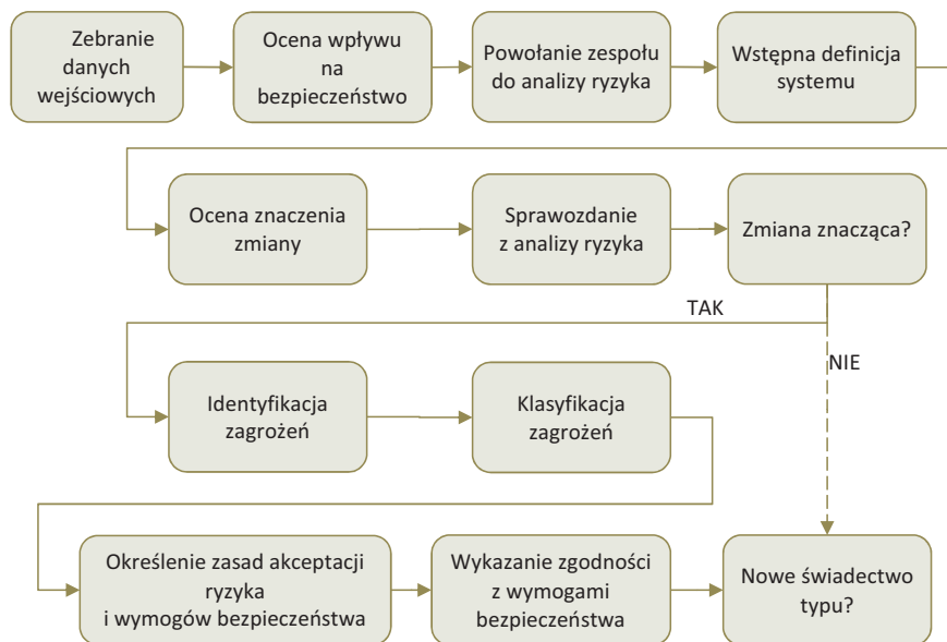
3. Schemat oceny ryzyka związanego ze zmianą urządzenia typu źródło: opracowanie własne
