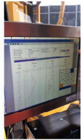
2. Widok systemu kontroli jakości i rejestracji danych wraz z panelem kontroli produkcji w kabinie operatora [4]
