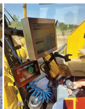
6. Maszyna wyposażona w system pozycjonowania GPS [4]
