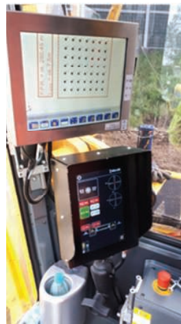
2. Widok systemu kontroli jakości i rejestracji danych wraz z panelem kontroli produkcji w kabinie operatora [4]
