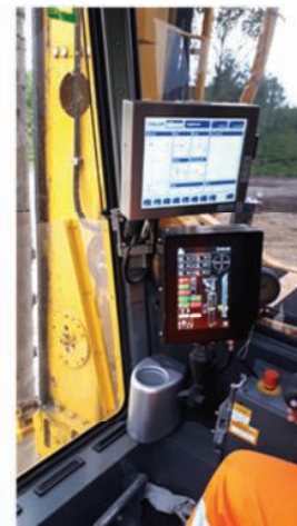
2. Widok systemu kontroli jakości i rejestracji danych wraz z panelem kontroli produkcji w kabinie operatora [4]
