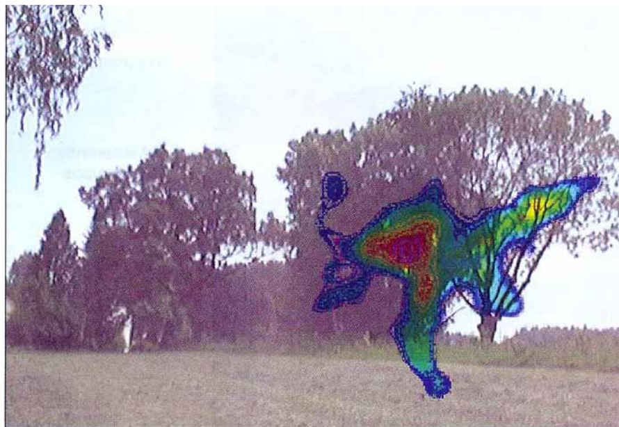
7. Obraz linii stałego natężenia dźwięku rozproszonego dla częstotliwości 400 – 1000 Hz
