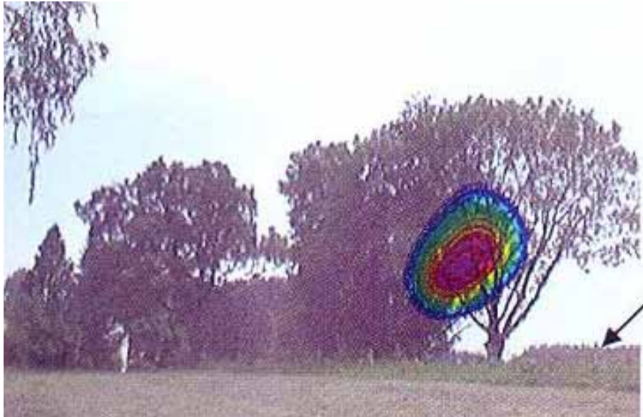
7. Obraz linii stałego natężenia dźwięku rozproszonego dla częstotliwości 400 – 1000 Hz
