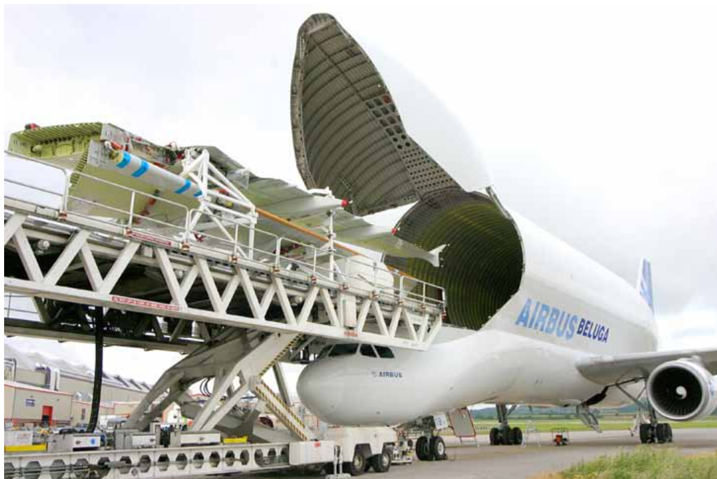
13. A300-600 Beluga jest wykorzystywany do transportu elementów konstrukcyjnych do budowy samolotów Airbusa
