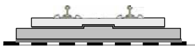
18. Typowa konstrukcja nawierzchni szynowej na płycie na mostach betonowych: nadbudowa nawierzchni szynowej na płycie, wypełnienie betonem płyty, warstwa elastomerów, płyta pośrednia zbrojona, warstwa ochronna za betonem, izolacja na poziomie mostu, poziom mostu
