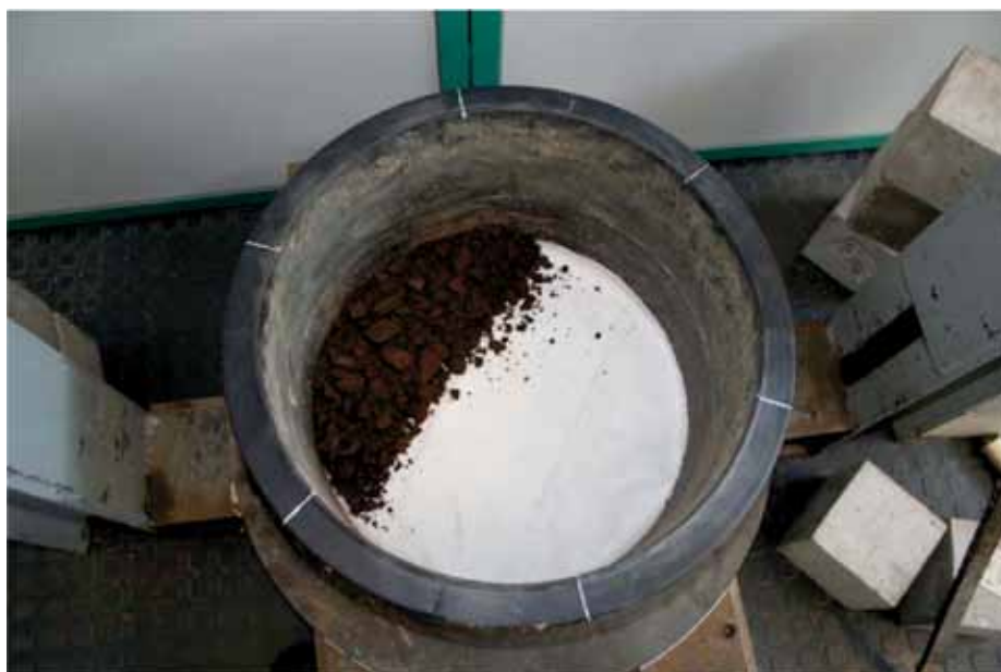
2. Przygotowanie stanowiska badawczego geowłóknina + niesort
