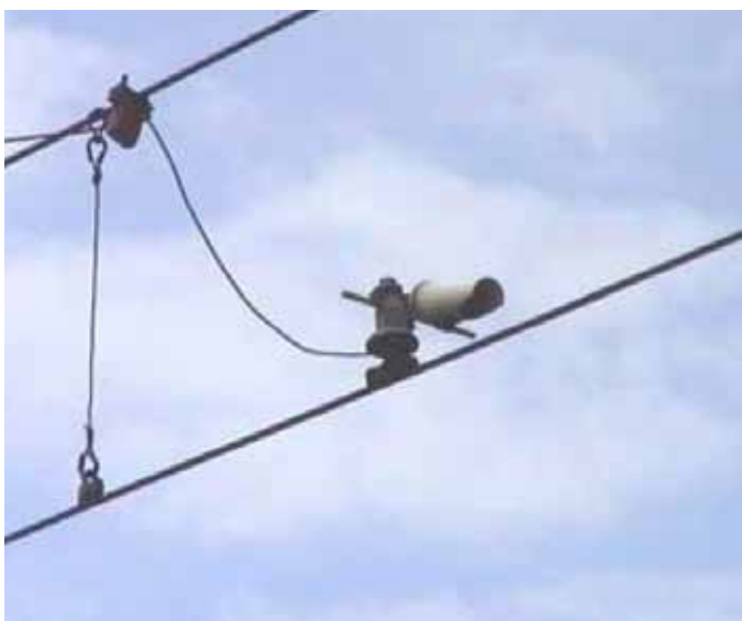
4. Odbiornik sygnału podczerwieni i oznakowana na trakcji strefa zgłoszenia - wysłania sygnału
