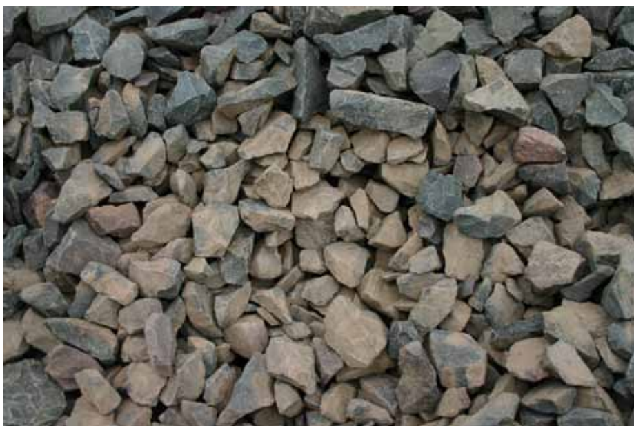
9. Zabrudzony tłuczeń (na górze zdjęcia widać tłuczeń ołukany)
