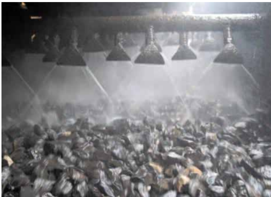
4. Płukanie tłucznia w maszynie PM 200-2R [9]
