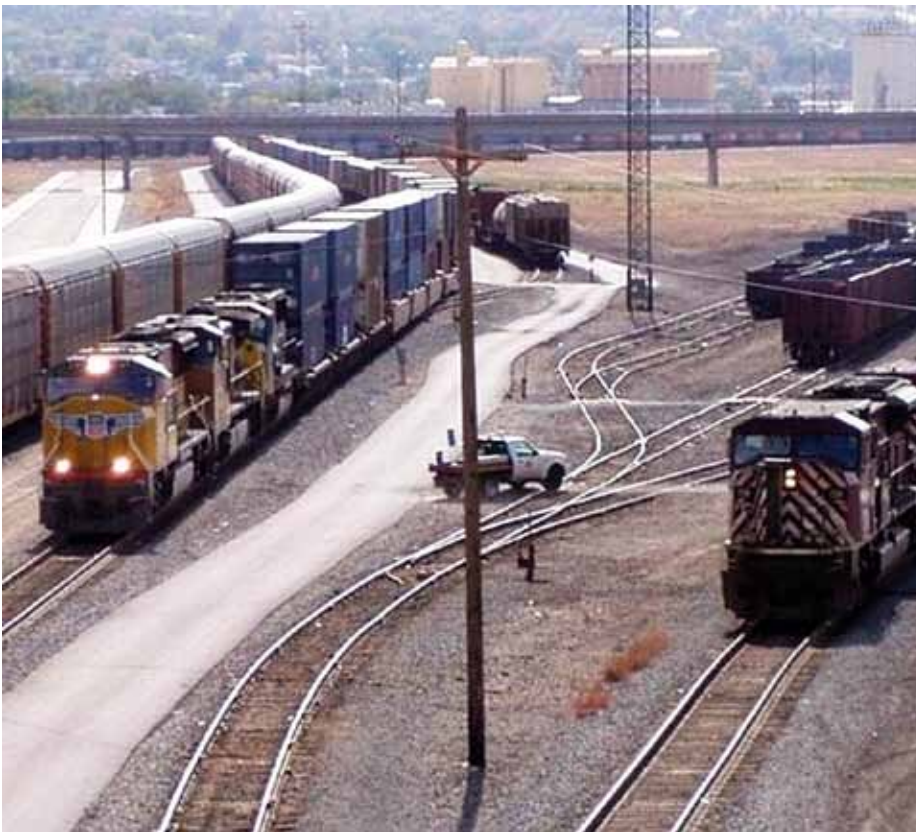
4. Tabor kolejowy jest „wysoki”, pociągi towarowe przewożą dwie warstwy kontenerów
