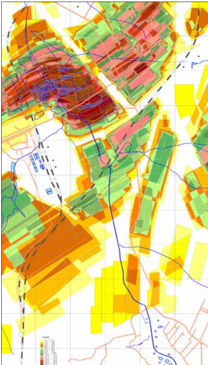
2. Obniżenia terenu w rejonie linii kolejowej 149 wywołane eksploatacją dokonaną KWK „Knurów-Szczygłowice” Ruch Szczygłowice
