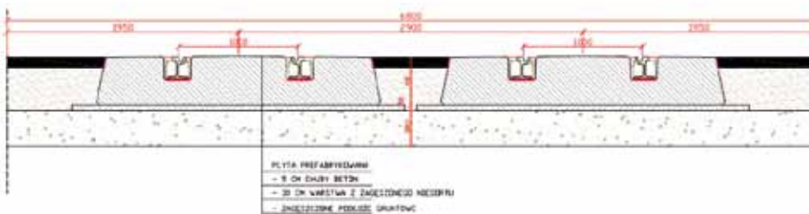
4. Przekrój poprzeczny pasa autobusowo-tramwajowego w Toruniu
