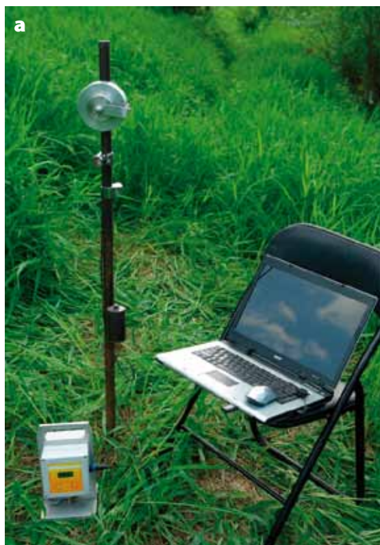
5. Przyrząd MPL-01: a – podczas pomiaru ugięć mostu, b – widok ogólny z mocowaniem na statywie
