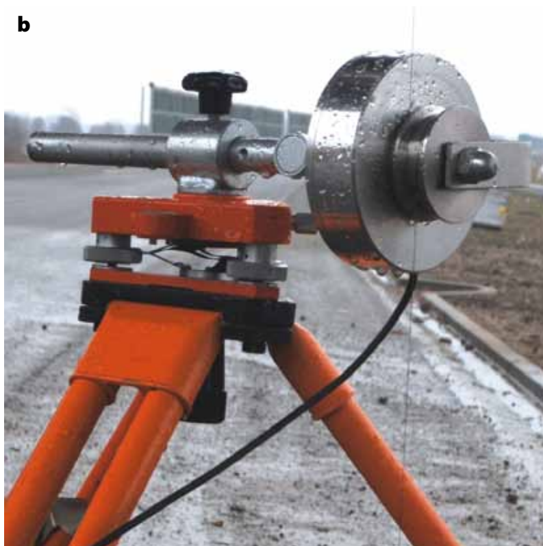
5. Przyrząd MPL-01: a – podczas pomiaru ugięć mostu, b – widok ogólny z mocowaniem na statywie
