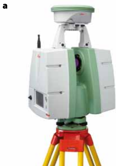
1. Wybrane modele naziemnych, stacjonarnych skanerów laserowych: a – Leica ScanStation C10, b – Riegl VZ-400, c – Topcon GLS-1500
