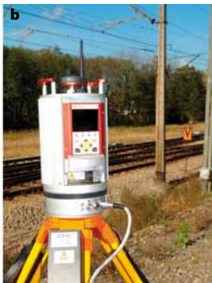
1. Wybrane modele naziemnych, stacjonarnych skanerów laserowych: a – Leica ScanStation C10, b – Riegl VZ-400, c – Topcon GLS-1500
