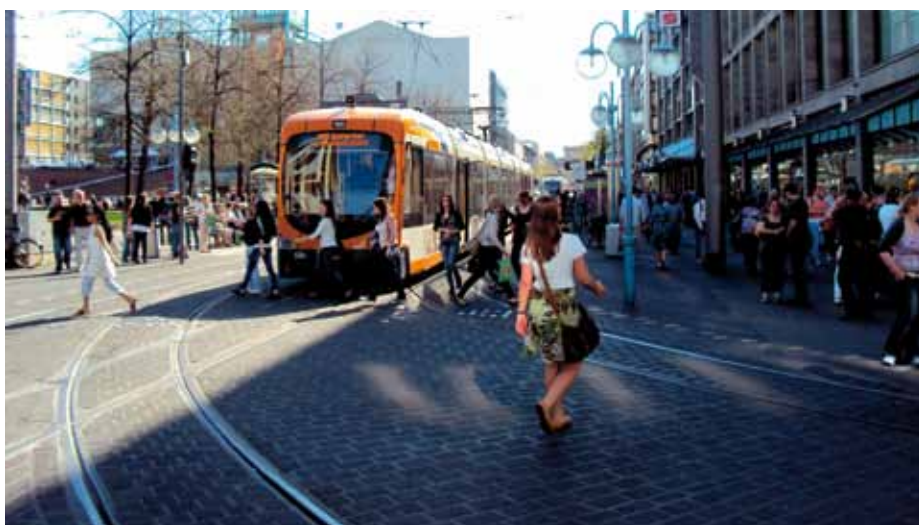
8. Prowadzenie torów tramwajowych w Mannheim w poziomie deptaku wymaga ograniczenia prędkości tramwajów do 25 km/h. Jaka infrastruktura na styku chodnik-torowisko powinna być wymagana aby tramwaj mógł jechać 50 km/h?
