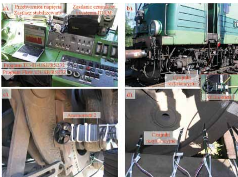
6. Widok lokomotywy EU-07 w czasie montażu czujników do badań aerodynamicznych
