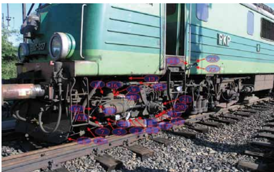
7. Widok rozmieszczenia czujników prędkości powietrza w otoczeniu układu KKH
