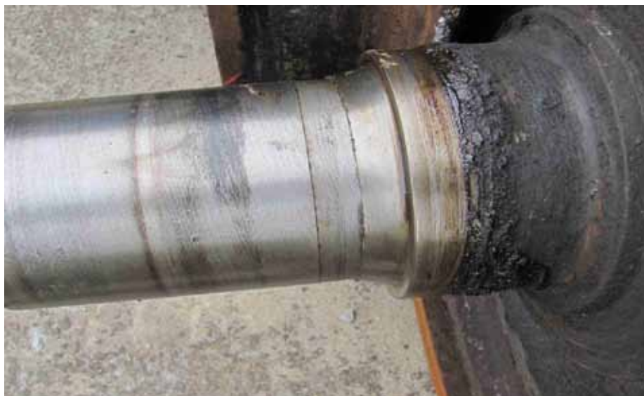
3. Wytarcie czopa osi A Ø120x179 mm zestawu kołowego wagonu towarowego Źródło: PKP CARGO S.A., warsztat utrzymania PKP CARGO S.A. w Jaśle
