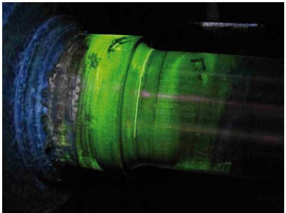
1. Nieciągłość na przejściu czopa w przedpiaście osi typu A \varnothing 120 \times 179 mm zestawu kołowego wagonu towarowego, wykryta metodą UT badaniem od czopa osi, a następnie potwierdzona badaniami MT
