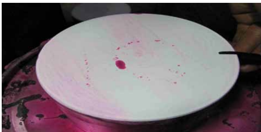
5. Nieciągłości wewnętrzne w części środkowej osi wykryte metodą UT, potwierdzone badaniami PT po przecięciu osi
