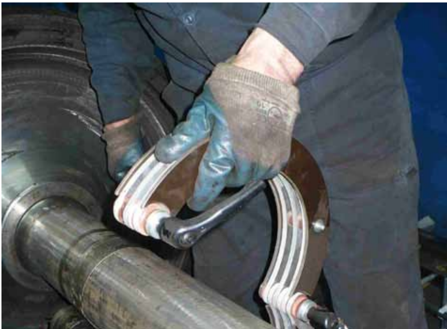
8. Cewka półotwarta do badań MT. Badanie wykonywane w świetle UV. Magnesowanie wzdlużne i poprzeczne jednocześnie
