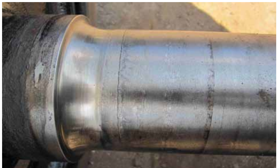
2. Nieciągłość w czopie osi typu A \varnothing 120 \times 179 mm zestawu kołowego wagonu towarowego wykryta metodą UT (badania częściowo uproszczone wg BN-77/3518-02, arkusz 4), a potem potwierdzona badaniami szczegółowymi głowicą na fale poprzeczne. Na czopie widoczne ślady pogorszenia chropowatości powierzchni
