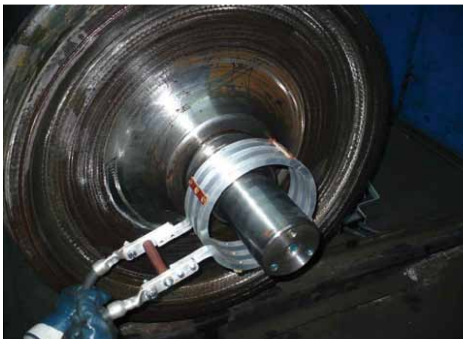
7. Cewka do badań MT. Badanie wykonywane w świetle UV. Magnesowanie wzdłużne i poprzeczne jednocześnie
