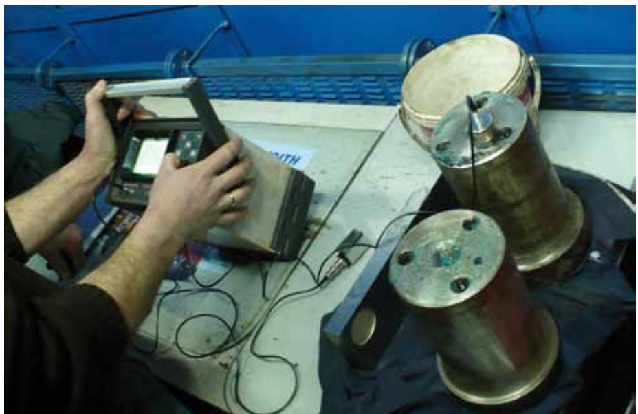
10. Defektoskop ultradźwiękowy DI-60 firmy Metrison. Wycinki osi zestawów kołowych do wagonów towarowych z pęknięciami zmęczeniowymi wykrytymi w czasie badania UT Źródło: PKP CARGO S.A., warsztat utrzymania PKP CARGO S.A. w Jaśle
