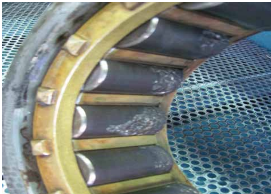
4. Uszkodzone łożysko zestawu kołowego do wagonu towarowego – ślady działania łuku elektrycznego
