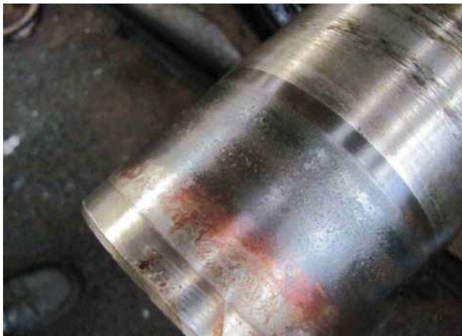
6. Korozja typu fretting na czopie osi (ślady działania wody). Niedopuszczalna chropowatość powierzchni czopa osi
