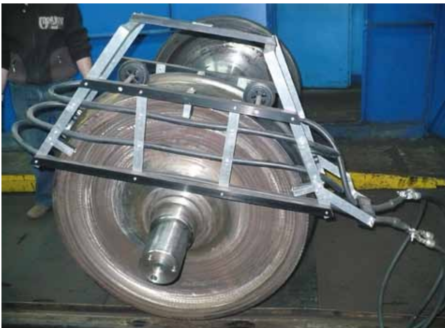
9. Klatka do badań MT tarczy kół zestawów kołowych
