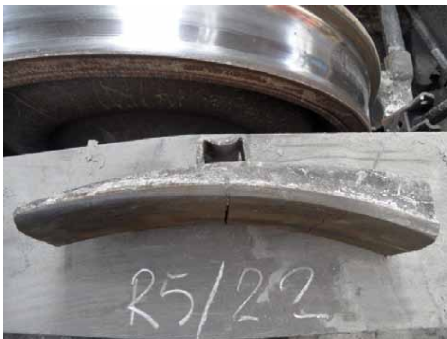
9. Zużycie klinowe kompozytowej wstawki hamulcowej w układzie 2Bg
