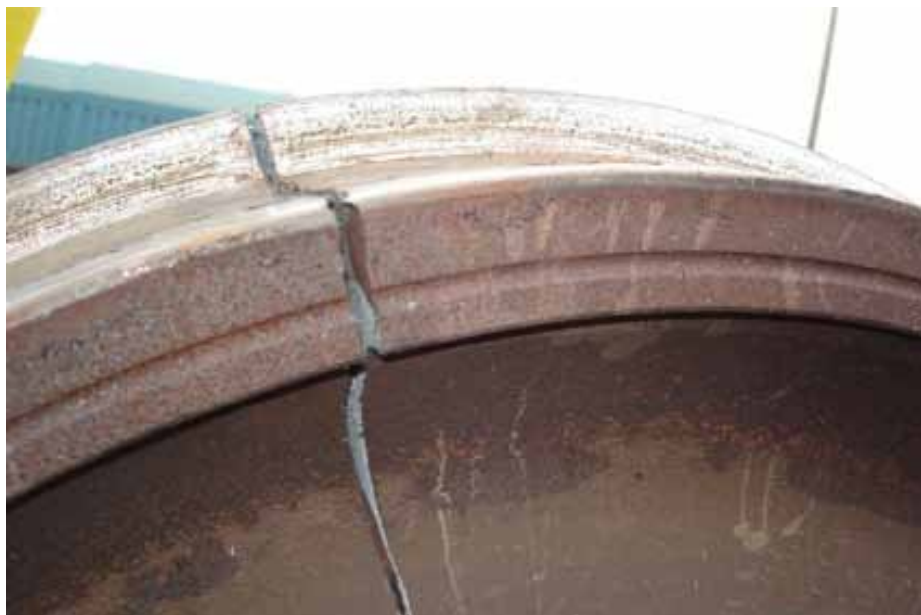
2. Pęknięty wieńiec koła
