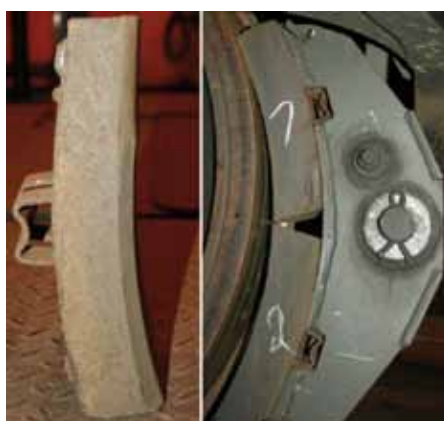
10. Zużycie klinowe kompozytowej wstawki hamulcowej w układzie 2Bgu
