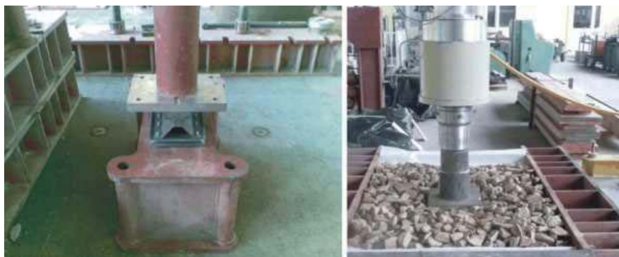
8a. Badania wytrzymałościowe obudowy czujników
