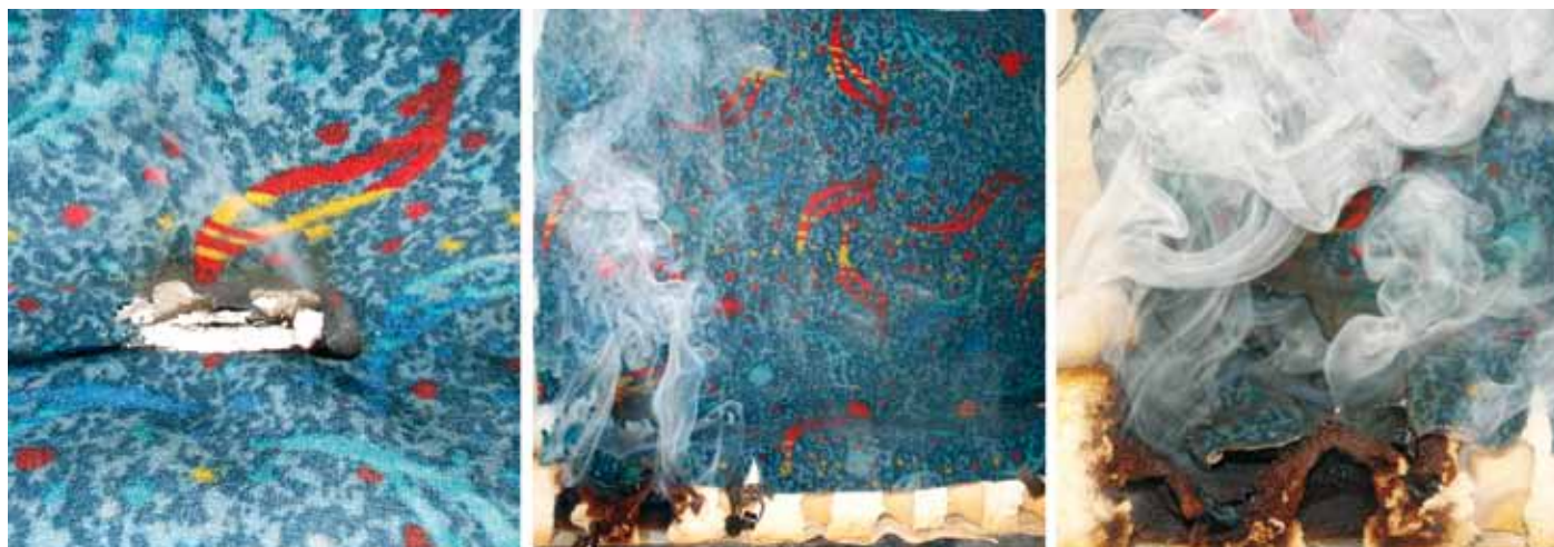
2. Układ tapicerski podczas badania wg PN-EN 1021-1
