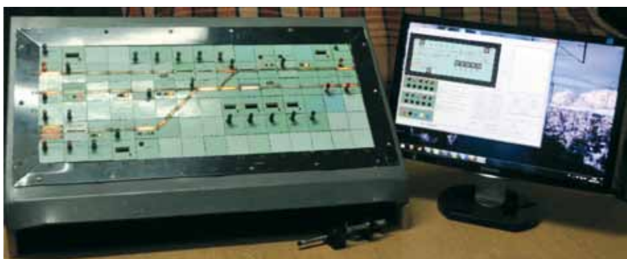
6. Widok symulatora wykorzystującego rzeczywisty pulpit nastawczy, opartego na modułach programowych ISDR
