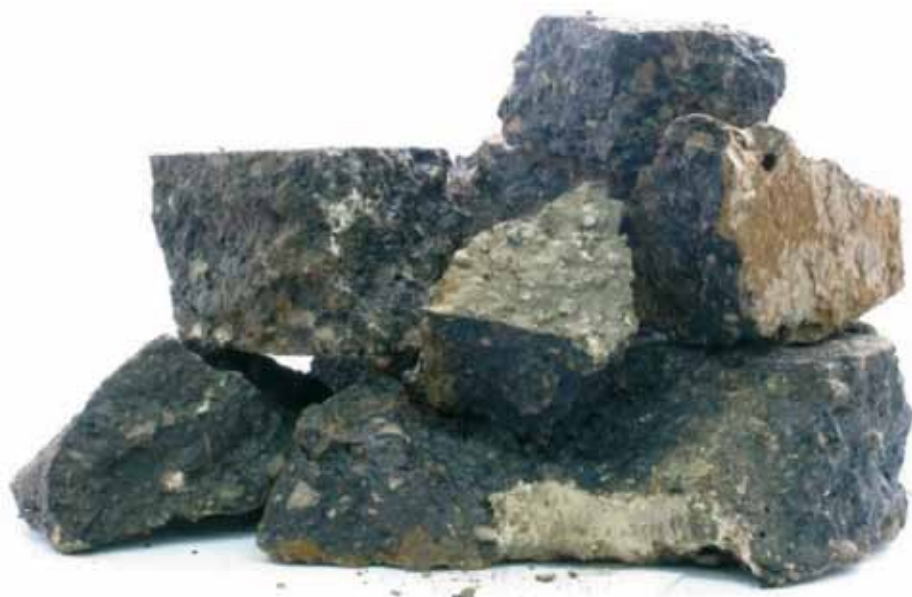
11. Próbki masy mineralno asfaltowej
