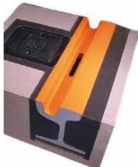
1. Zasada szyny w otulinie we współczesnych torowiskach tramwajowych
