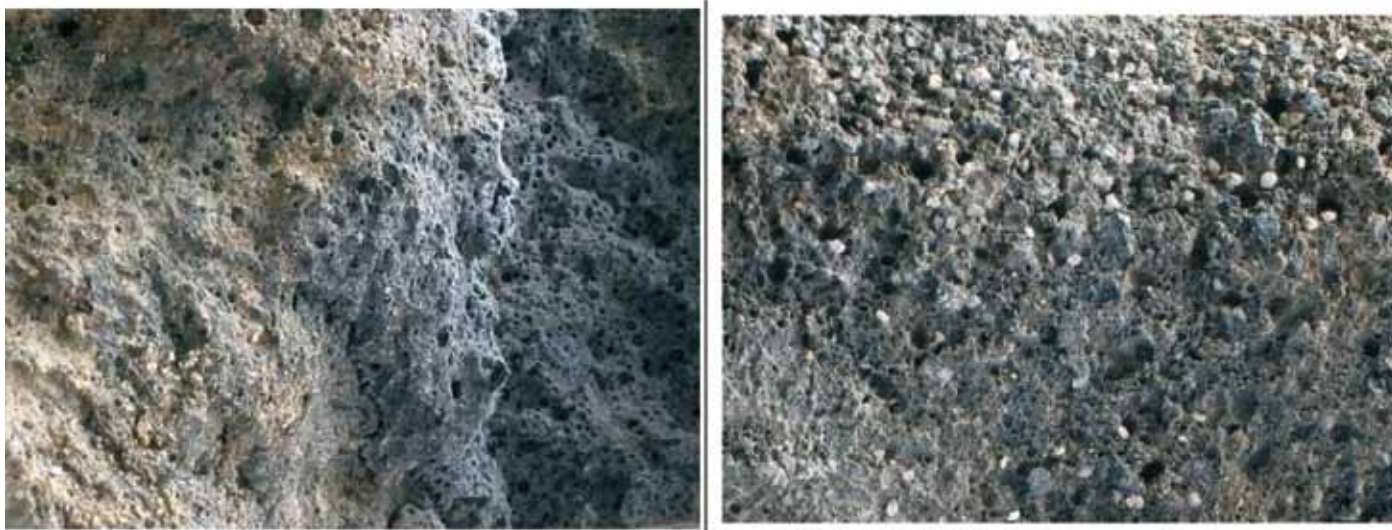
13. Powiększenia struktury wewnętrznej próbki masy zalewowej Edilon-Corkelast
