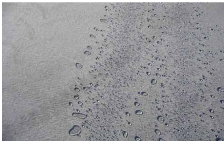
2. Widok efektu hydrofobowego na betonowej płycie lotniskowej
