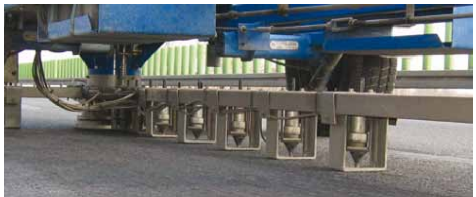
3. Widok geofonów i płyty naciskowej
