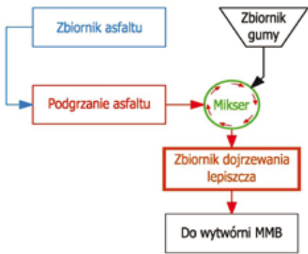
1. Schemat procesu modyfikacji asfaltu gumą
