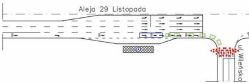
3. Zakłócenia spowodowane przez pojazdy transportu indywidualnego skręcające w prawo (źródło: opracowanie własne)
