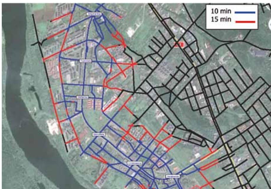
7. Odcinki ulic znajdujące się w izochronach dostępu do tramwaju w dzielnicy Tarchomin przy częstotliwości F = 15 poj./h
