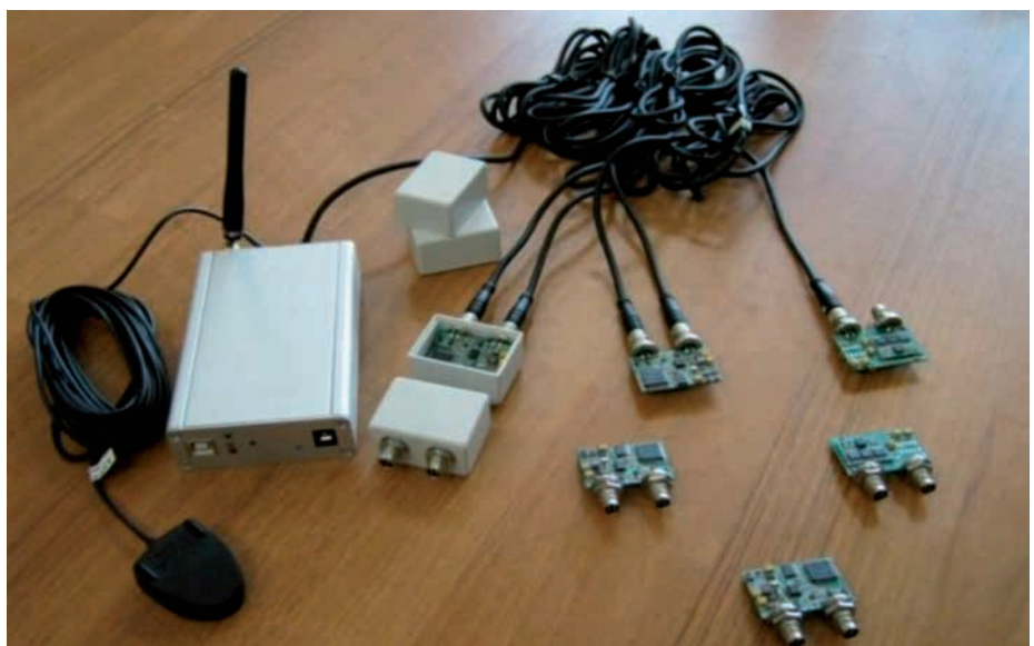
2. Widok ogólny prototypu systemu monitorowania stanu technicznego pojazdu
