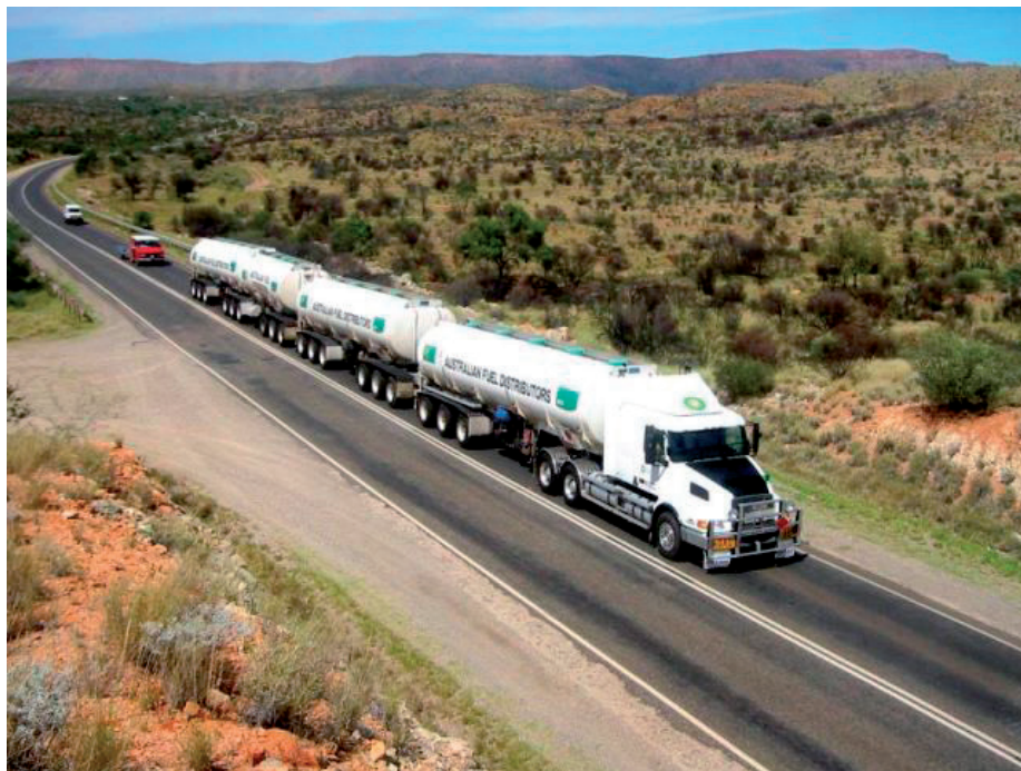
3. Pociąg drogowy do przewozu paliw płynnych (Australia) [25]
