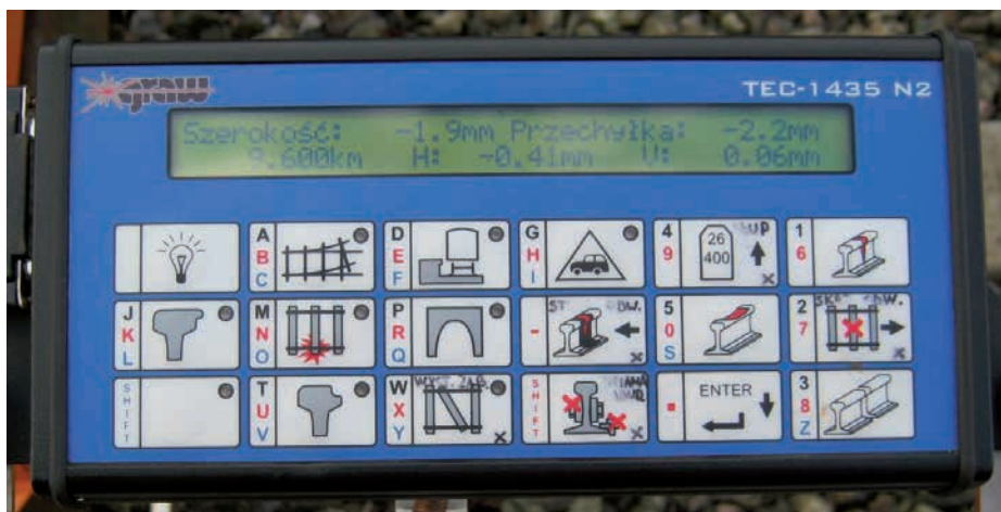
2. Rejestrator pomiarów toromierza (wyświetlacz i pulpity przycisków)
