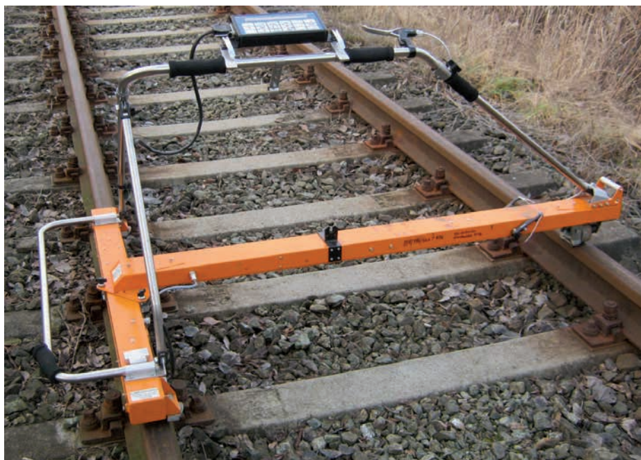
1. Toromierz TEC-1435 przygotowany do wykonania pomiarów geometrii toru
