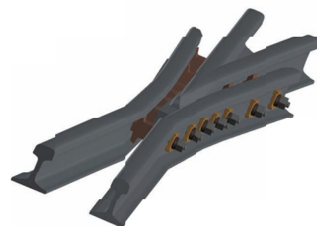
14. Krzyżownica z dziobnicą ze stali perlityzowanej na sieci PKP PLK
