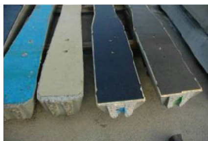
1. Wibroizolacja z poliuretanu firmy Getzner [6]
