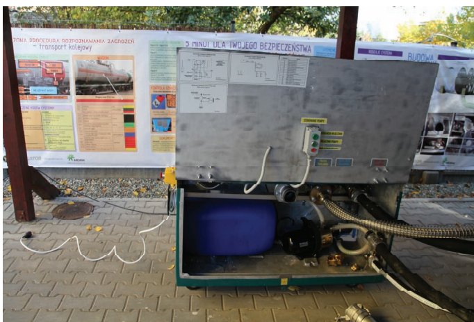
1. Symulator NO. Widok na część „stacjonarną” - symulacja zbiornika odbiorczego / nadawczego. Źródło: M. Rozycki
