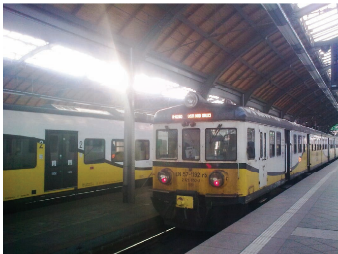
2. Nowy i stary EZT na Dworcu Głównym we Wrocławiu. Widać istotną różnicę w budowie okien
