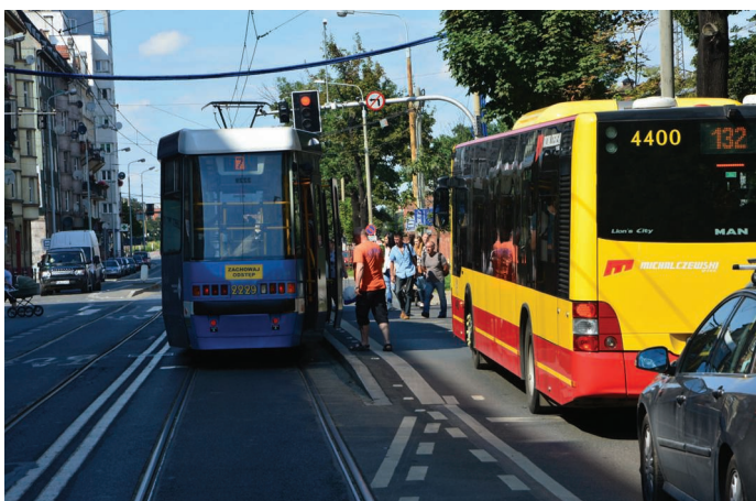
3. Przystanek wiedeński „Trzebnicka” – ul. Trzebnicka we Wrocławiu (fot. S. Kowerski)
