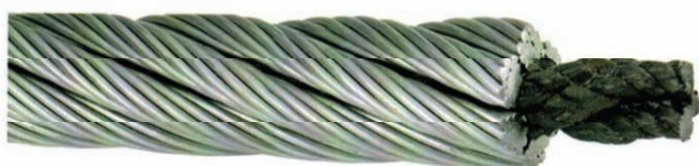
11. Lina o konstrukcji 6x25F z rdzeniem polipropylenowym powszechnie stosowana w kolejach linowych
