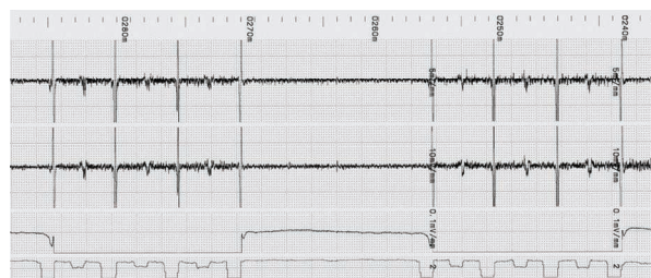
16. Przykładowy wydruk zarejestrowany defektografem MD120 podczas badania liny
