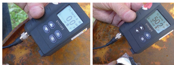
11. Kalibracja przyrządu do pomiaru grubości powłoki antykorozyjnej (po lewej wzorzec, po prawej wzorzec + folia dystansowa o grubości 49,5 \pm 1 \mu\text{m} )
