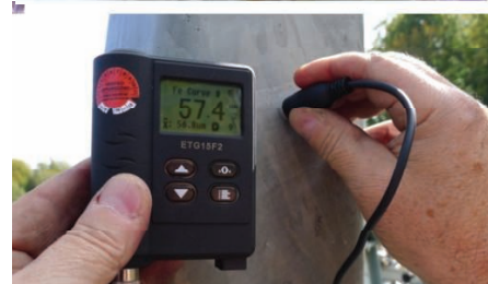
12. Przykładowe pomiary na głowicy podpory w materiale rodzimym
