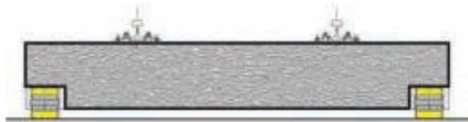
4. Wibroizolatory KY w bezpodsypkowej nawierzchni szynowej (GERB)
