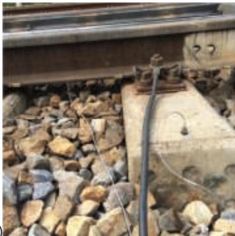
9. Aparatura pomiarowa i lokalizacja czujników pomiarowych w rozjeździe, a- czujniki na szynie i podrozjazdnicy, b- czujniki w podtorzu
