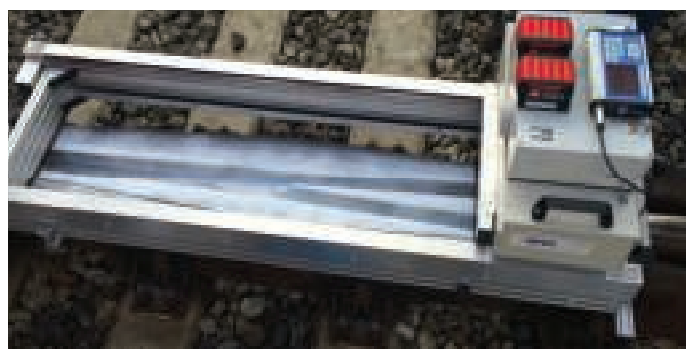
4. Skaner 3D Skorpion - krzyżownica w rozjeździe z PPP
